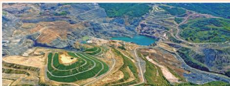
山西大同浑源矿山生态修复工程采用地貌重塑、土质重构、水土保持、植被重建及养护等一系列技术手段，修复矿区遭受破坏的地质生态环境，重塑恒山新生态。
