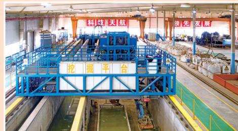
国内最大的挖泥船挖掘实验平台，实验平台按照国际一流标准设计建造，可模拟绞吸船、耙吸船各种土质条件下挖掘试验。
