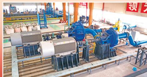
世界最大的泥泵及管路输送实验平台，实验平台技术能力达到国际领先水平，可依托平台开展一系列疏浚关键技术研究。
